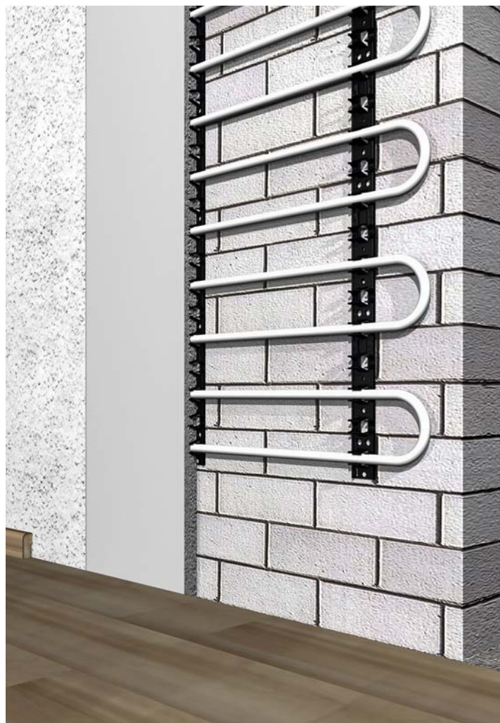
Flächenheizungen lassen sich nicht nur im Fußboden realisieren, sondern auch als Wandheizung
