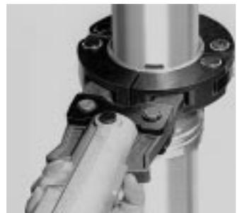
**2. Montageschritt: Pressbacke in die Presskette einstecken und Pressvorgang auslösen**
