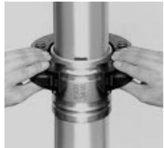
**1. Montageschritt: Rohr bis zur markierten Einstecktiefe in die Muffe stecken und passende Presskette auf die Muffe setzen**
