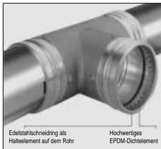
**Ein in den Fitting integrierter Edelstahlzahnring hält das eingesteckte Rohr in Achsrichtung fest, für Dichtheit sorgt der EPDM-O-Ring**
